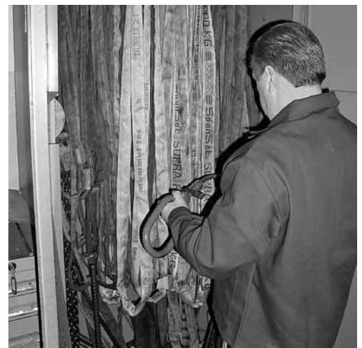
Bild 8: Die Anschlagmittel müssen von jemandem kontrolliert werden, der die erforderlichen Kenntnisse besitzt.
