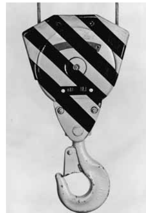
Bild 3: Gesicherte Einzugsstelle an Seilrolle.
